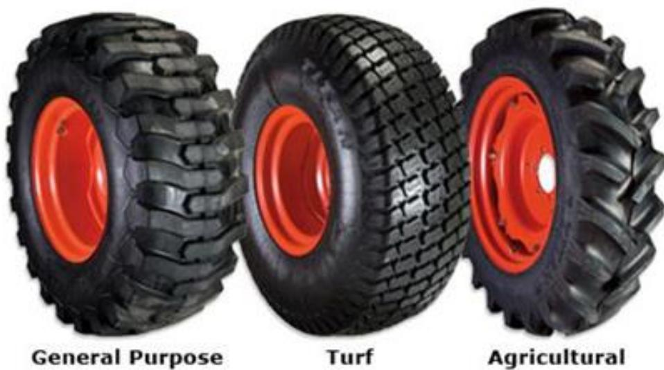
Slika 12. Tipovi traktorskih pneumatika ovisno o njihovom mjestu primjene (Izvor:
