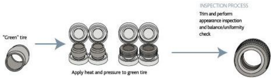
Slika 11. Očvršćivanje i inspekcija (Izvor: http://fleetsolution-mea.com/en/Pages/Tyre-Manufacturing )
