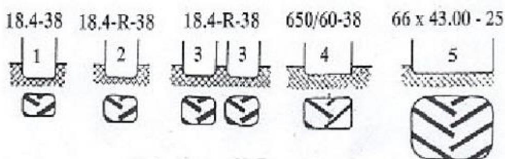
Slika 33. Kontaktne površine raznih konstrukcija guma 1- dihagonalna, 2- radijalna, 3- udvojene radijalne, 4- široka, 5-terra guma (Izvor: Zimmer i sur. 2009.)
