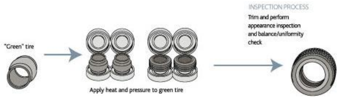
Slika 11. Očvršćivanje i inspekcija (Izvor: http://fleetsolution-mea.com/en/Pages/Tyre-Manufacturing )
