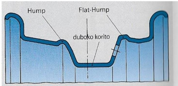
Slika 15. Nesimetrični naplatak s uzvišenjem (Hump felga) (Izvor: Popović, 2010.)
