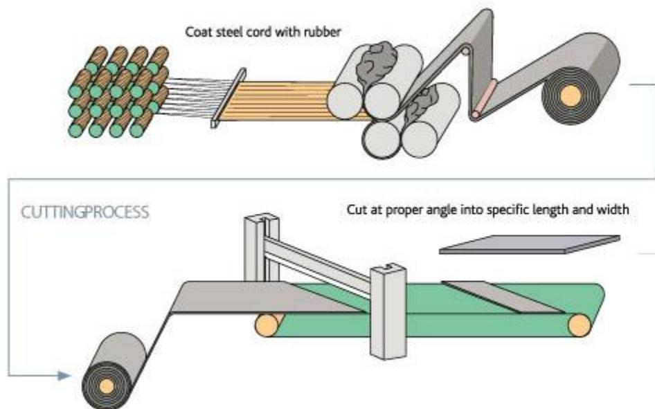
Slika 8. Proizvodnja čeličnog remena i čeličnog sloja (Izvor: <http://fleetsolution-me.com/en/Pages/Tyre-Manufacturing> )
