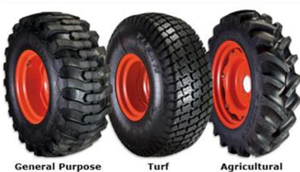
Slika 12. Tipovi traktorskih pneumatika ovisno o njihovom mjestu primjene (Izvor:
