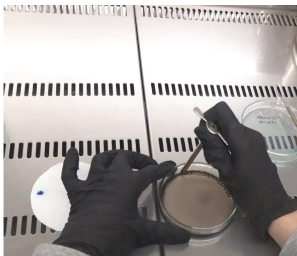
Slika 4. Izrezivanje kružnih isječaka podloge s micelijem gljive Izvor: Dujković, 2019.
