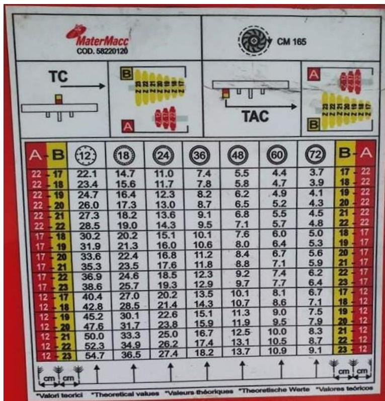
Slika 8. Prikaz potrebnih kombinacija lančanika kod izbora različitih otvora na sjetvenoj ploči za ostvarenje željenog razmaka unutar reda pri opsegu pogonskog kotača od 165 cm
