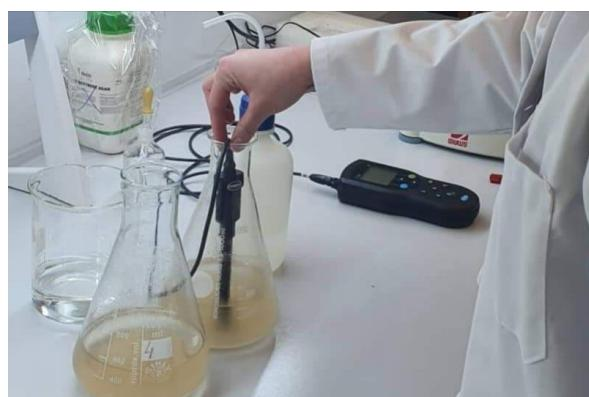
Slika 2. Mjerenje pH vrijednosti hranjive podloge
