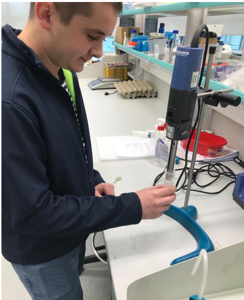
Slika 3. Rad na ultrazvučnom homogenizatoru T18 basic Ultra Turrax, IKA®
