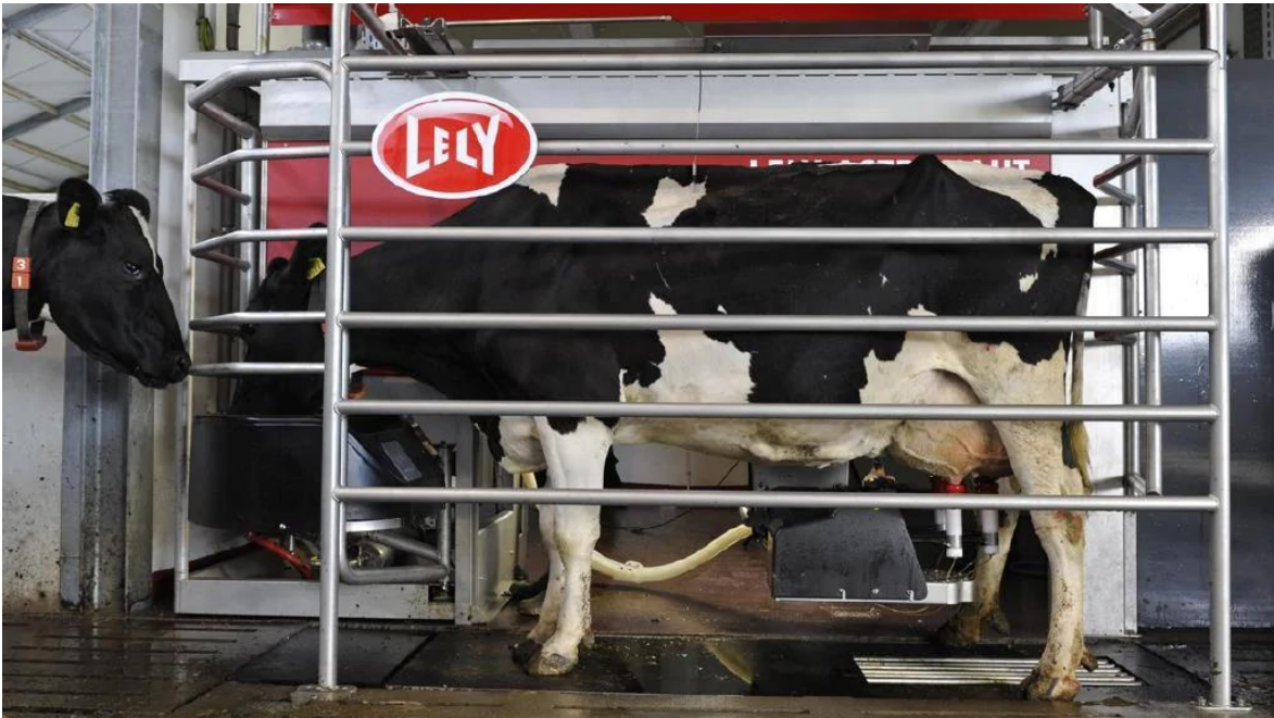
Slika 2. Automatizirani muzni sustav marke Lely
