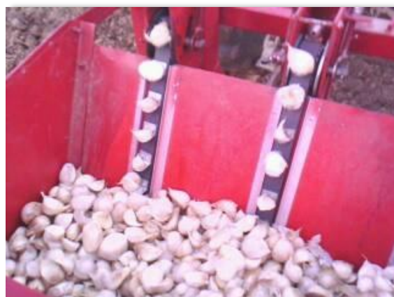
Slika 3. Princip rada sadilice
