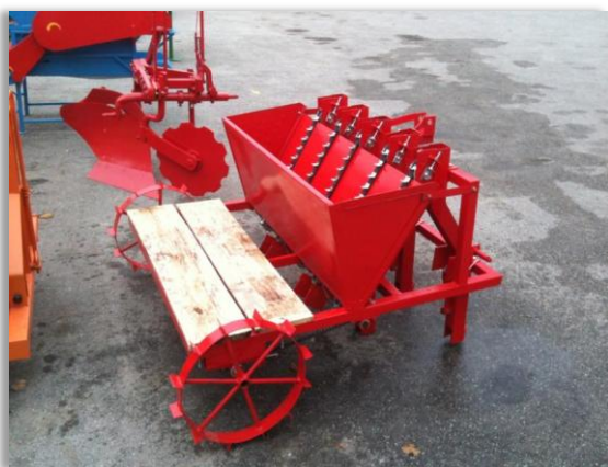
Slika 2. Sadilica za češnjak
