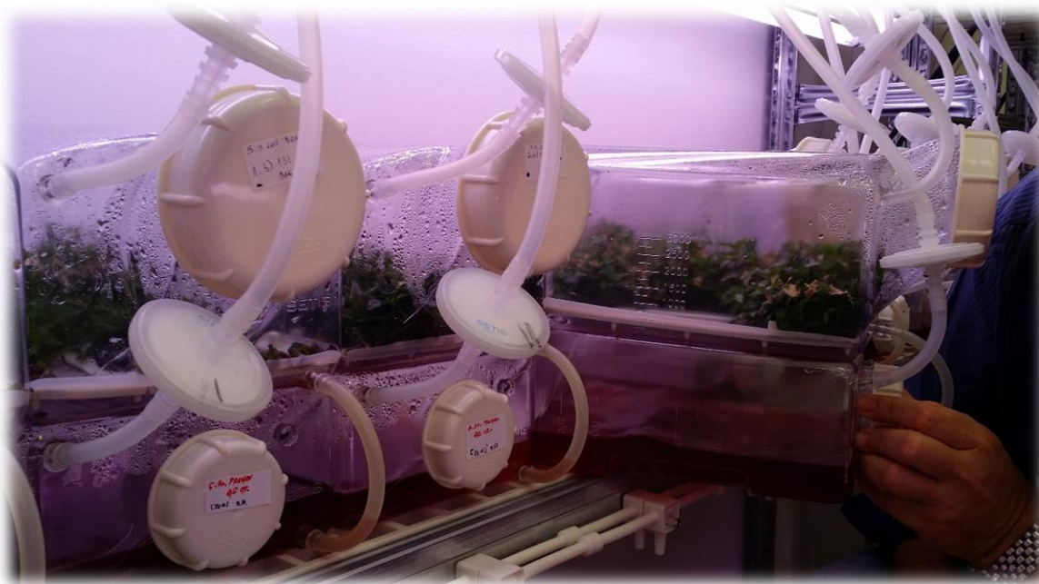
Slika 4. TIB sustav bioreaktora – Katedra za voćarstvo, vinogradarstvo i vinarstvo, FAZOS (Izvor: Bošnjak, 2020.)
