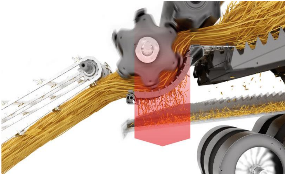
Slika 2. Vršidbeni uređaj na kombajnu Claas Tucano serije 320
