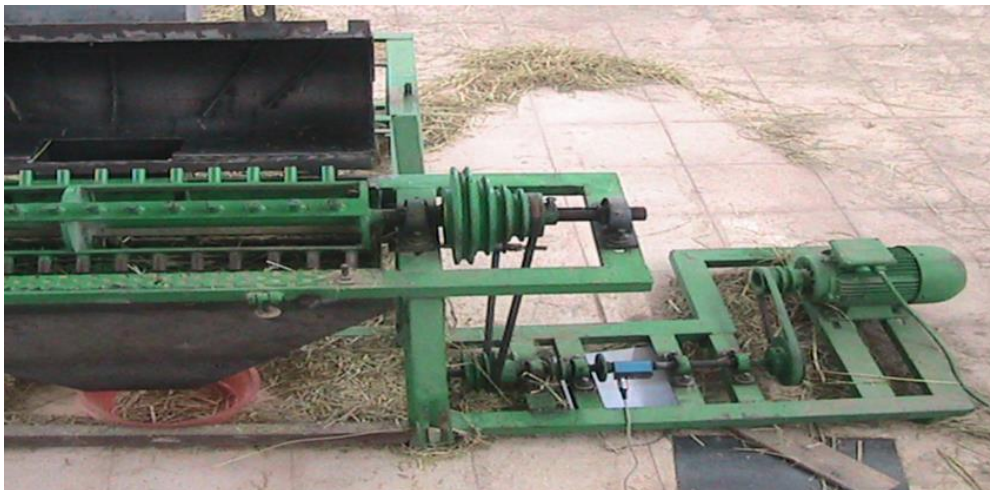
Slika 14. Aksijalni sustav izvršavanja dizajniran za potrebe istraživanja
