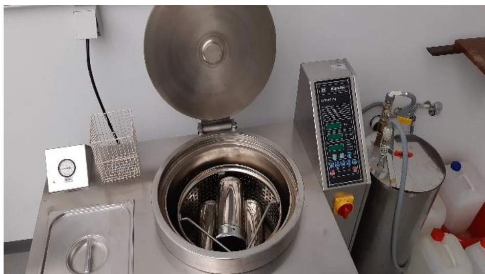
Slika 1. Petrijeve zdjelice u aluminijskim stalcima u autoklavu
