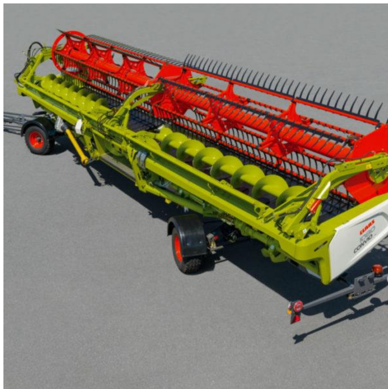
Slika 8. Transport hedera na transportnoj prikolici Izvor slike ( https://Transport hedera )
