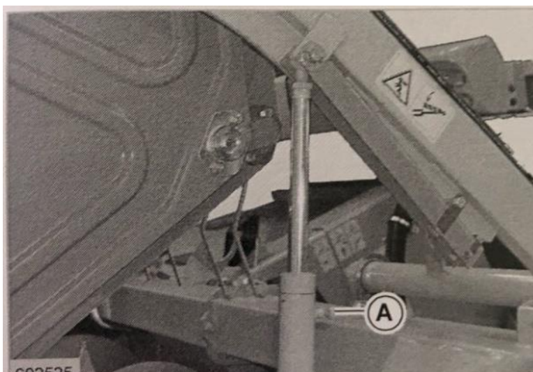
Slika 20. Prikaz kako odzračiti cilindar vitla
