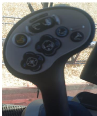
Slika 17. Upravljačka palica s najbitnijim funkcijama za podešavanje
