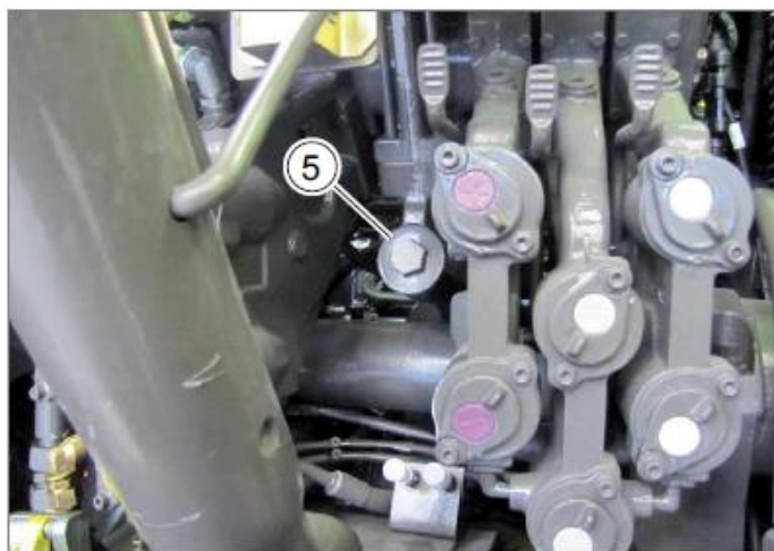
Slika 34. Prikazuje zamjenu ulja hidrauličkog sustava (Izvor: Radionički priručnik ARION 650 CLAAS , 2017.).
