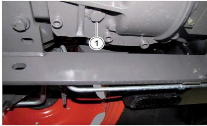
Slika 32. Prikazuje zamjenu ulja hidrauličkog sustava (Izvor: Radionički priručnik ARION 650 CLAAS , 2017.).
