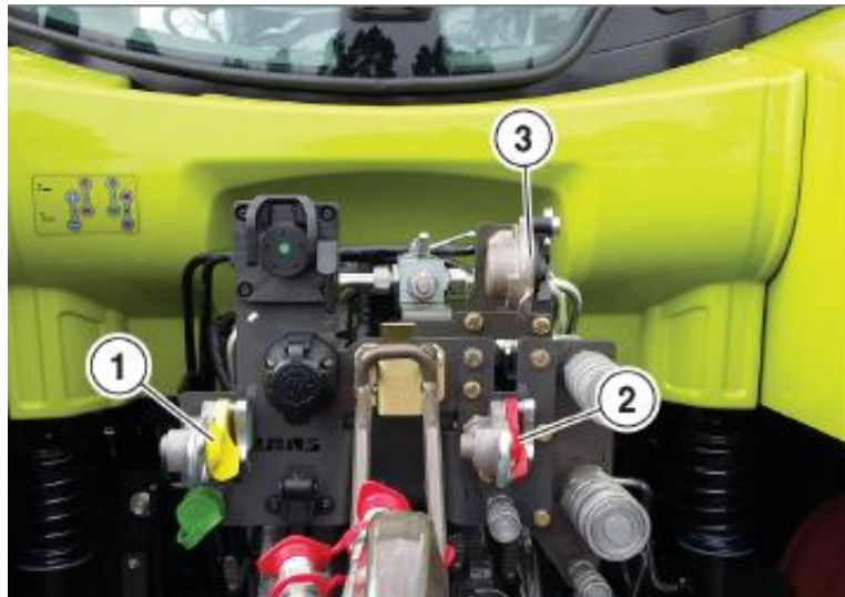
Slika 37. Prikazuje provjeru spojne glave pneumatskog kočionog sustava (Izvor: Radionički priručnik ARION 960 CLAAS , 2019 g.).
