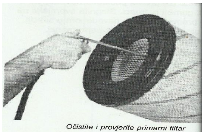
Slika 17. Prikazuje pravilno čišćenje filtera. (Izvor: John Deere 8230 (2008)).
