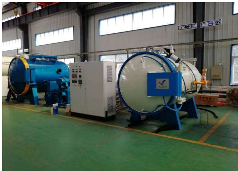
Slika 23. Horizontalne jednokomorne peći
