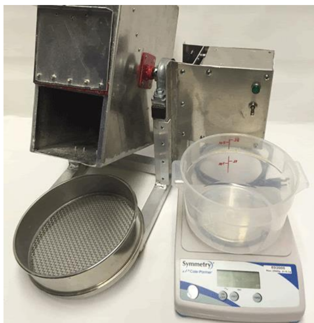
Slika 13. Uređaj za ispitivanje izdržljivosti peleta
