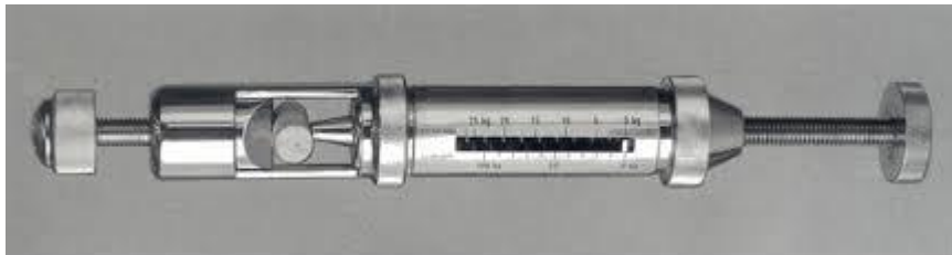
Slika 14. Ispitivanje izdržljivosti peleta pomoću opruge
