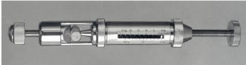
Slika 14. Ispitivanje izdržljivosti peleta pomoću opruge
