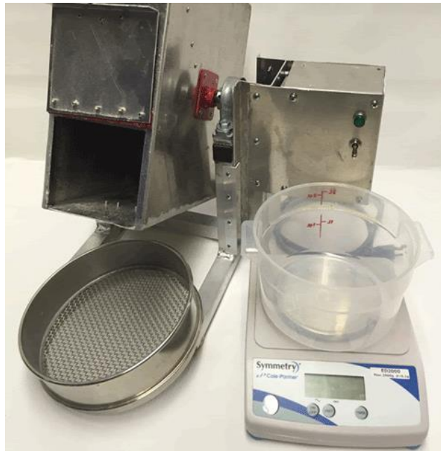
Slika 13. Uređaj za ispitivanje izdržljivosti peleta
