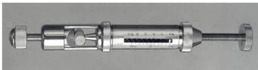
Slika 14. Ispitivanje izdržljivosti peleta pomoću opruge
