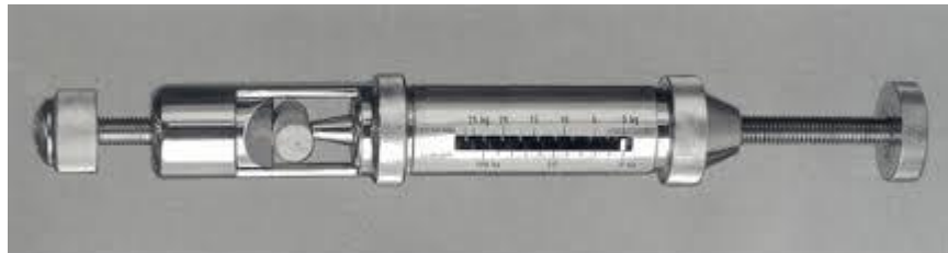
Slika 14. Ispitivanje izdržljivosti peleta pomoću opruge
