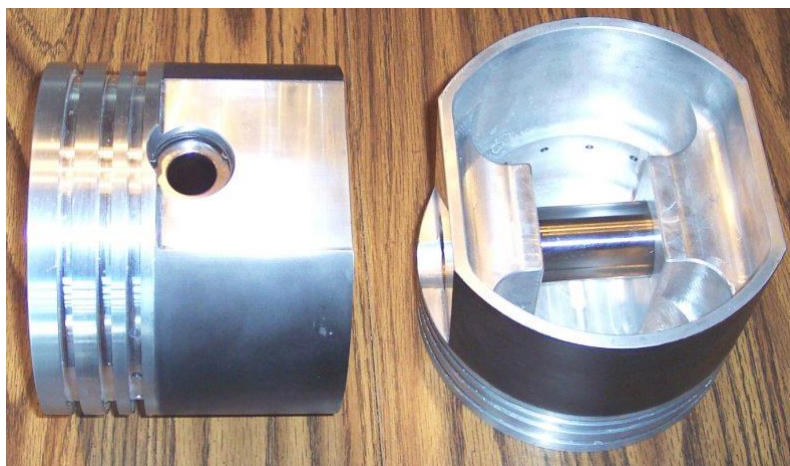
Slika 20. Aluminijski klipovi motora traktora John Deere ( https://www.murphysmotorservice.com/JDApistons2.jpg )
