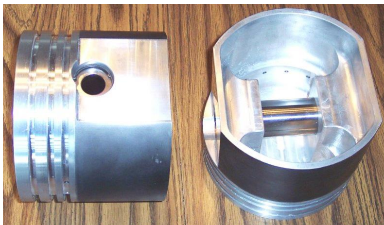
Slika 20. Aluminijski klipovi motora traktora John Deere ( https://www.murphysmotorservice.com/JDApistons2.jpg )
