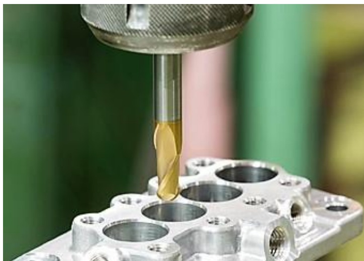
Slika 9. Bušenje rupa za pričvrstne vijke aluminijske glave motora ( http://www.usinagealuminium.com/ANGLAIS/index.php?id=2 )
