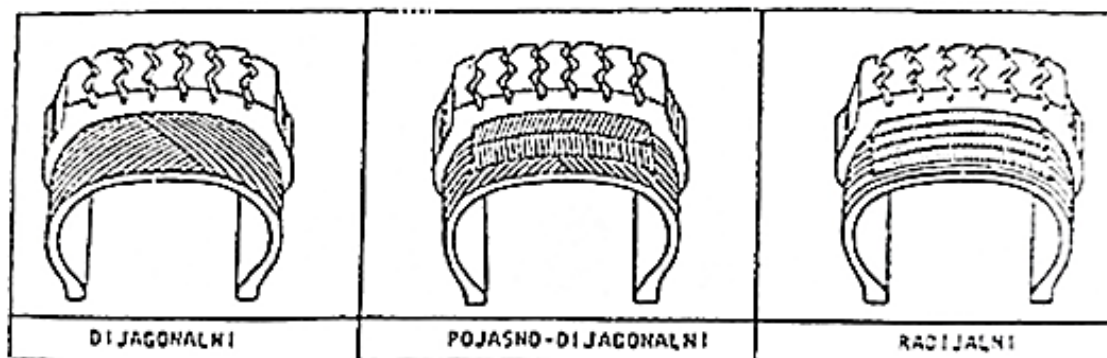
Slika 11. Osnovni tipovi pneumatika (Izvor: Brkić i sur., 2005.)
