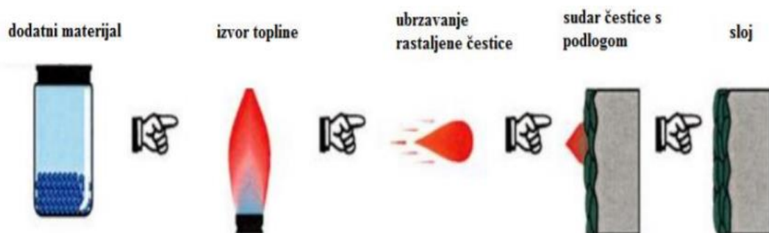
Slika 1. Faze nastanka sloja u procesu toplinskog naštrcavanja
