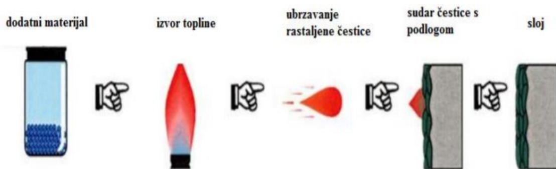
Slika 1. Faze nastanka sloja u procesu toplinskog naštrcavanja
