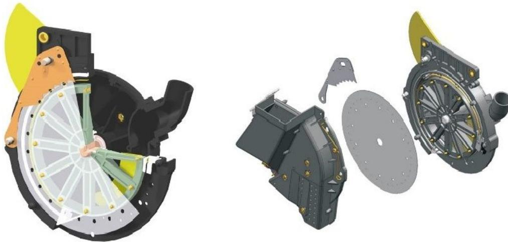
Slika 17. Kućište sjetvenog uređaja
