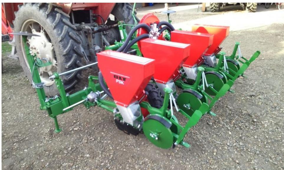
Slika 7. Pneumatska sijačica *PSK4*
