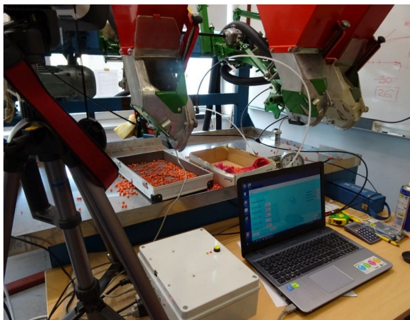
Slika 27. Programski sustav za kontrolu tehničkih čimbenika sjetve
