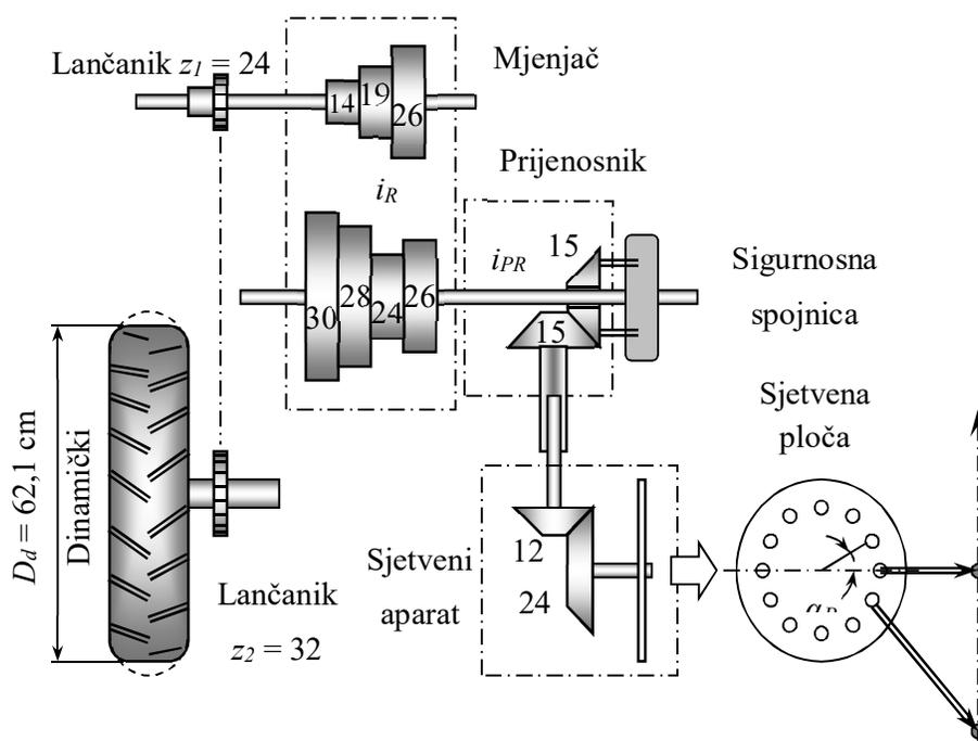
Slika 10. Prijenosni sustav lančanika kod sijačice PSK4
