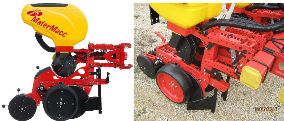
Slika 15. Sjetvena sekcija sijačice MaterMacc Twin Row-2
