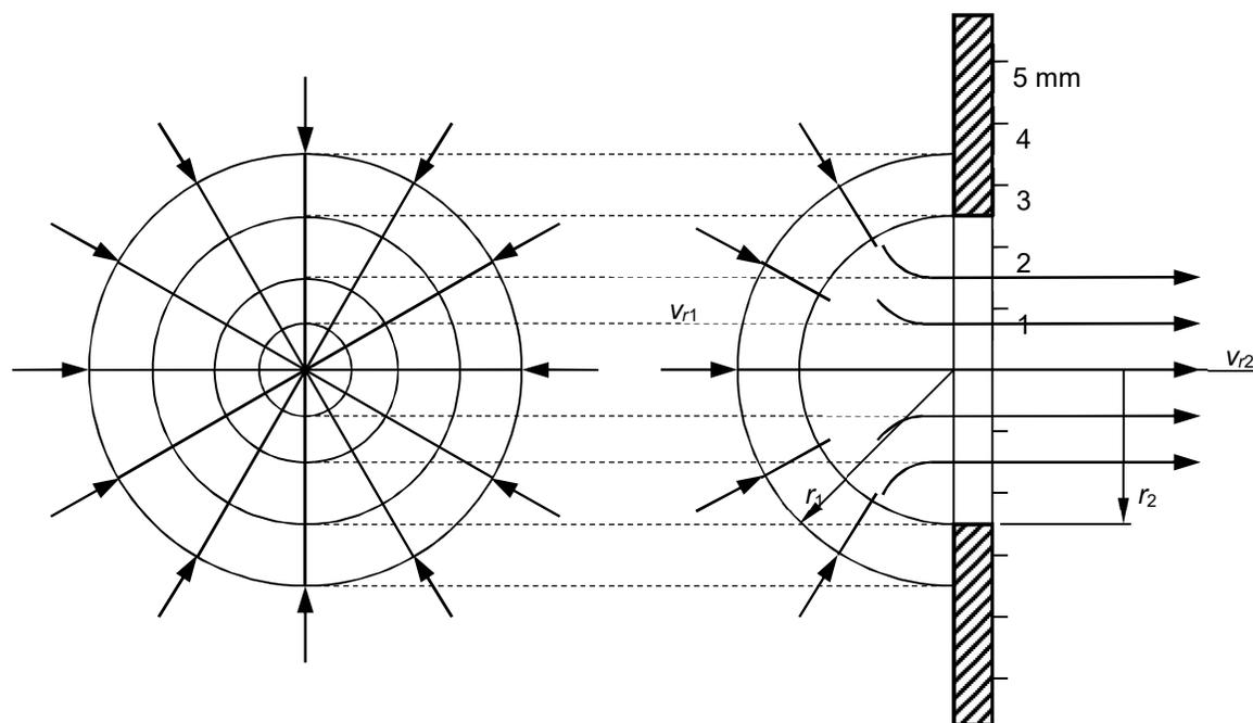
Slika 30. Prikaz djelovanja podtlaka na otvoru sjetvene ploče
