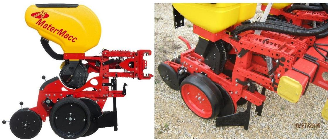
Slika 15. Sjetvena sekcija sijačice *MaterMacc Twin Row-2*
