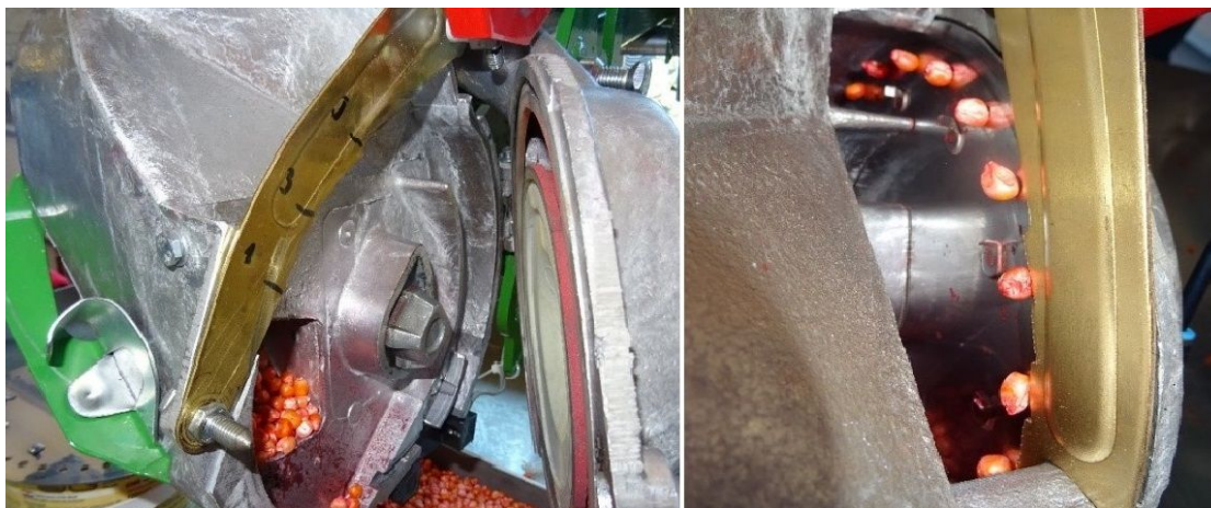
Slika 9. Komora za sjeme (lijevo) i skidač viška sjemena (desno)
