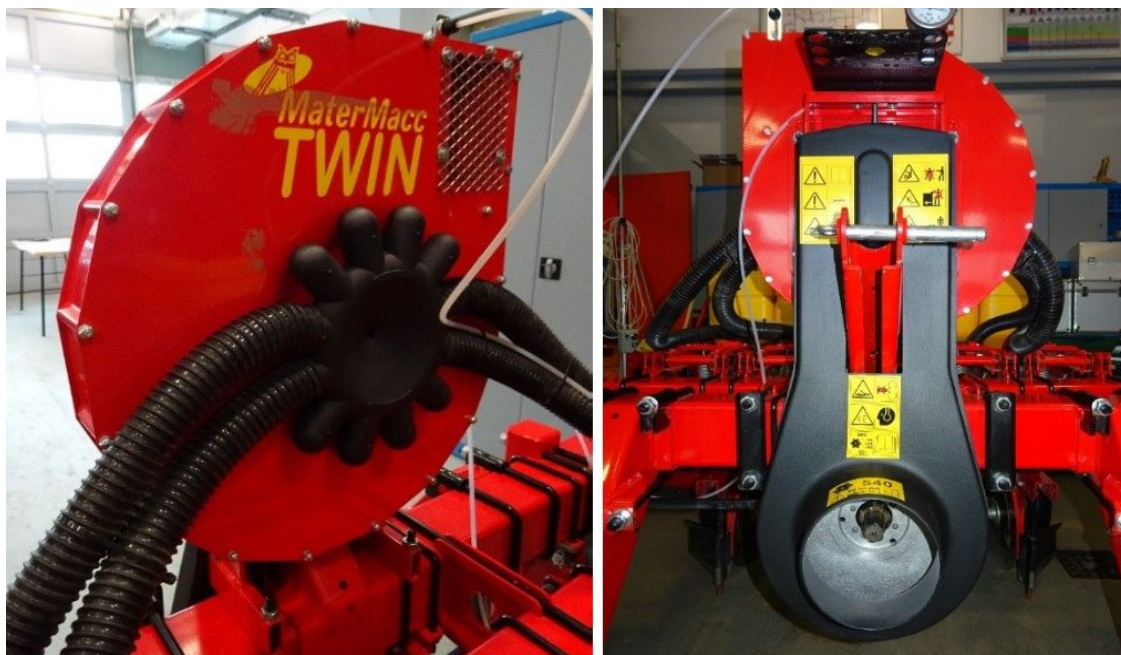
Slika 35. Sabirni ulaz cijevi iz sjetvenih kućišta na ventilatoru sijačice MaterMacc Twin Row-2 (lijevo) i pogonska remenica vratila ventilatora (desno)
