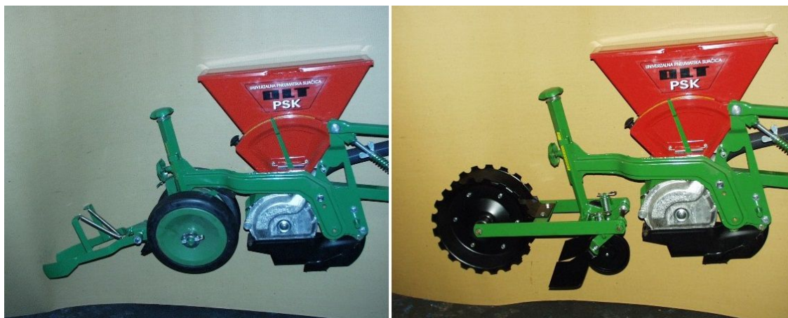
Slika 8. Različite izvedbe sjetvenih sekcija za sjetvu kukuruza
