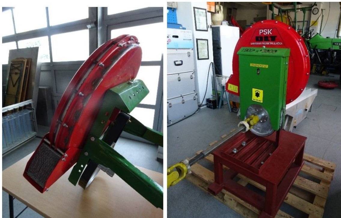
Slika 34. Radijalni ventilator sijačice PSK4
