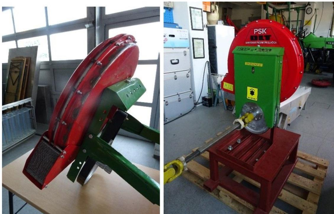
Slika 34. Radijalni ventilator sijačice *PSK4*
