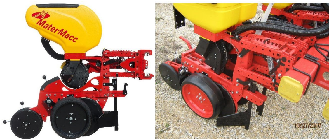
Slika 15. Sjetvena sekcija sijačice MaterMacc Twin Row-2
