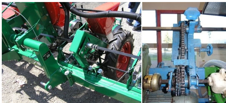
Slika 11. Pogon od pogonskog kotača (lijevo) i mjenjačka kutija (desno)
