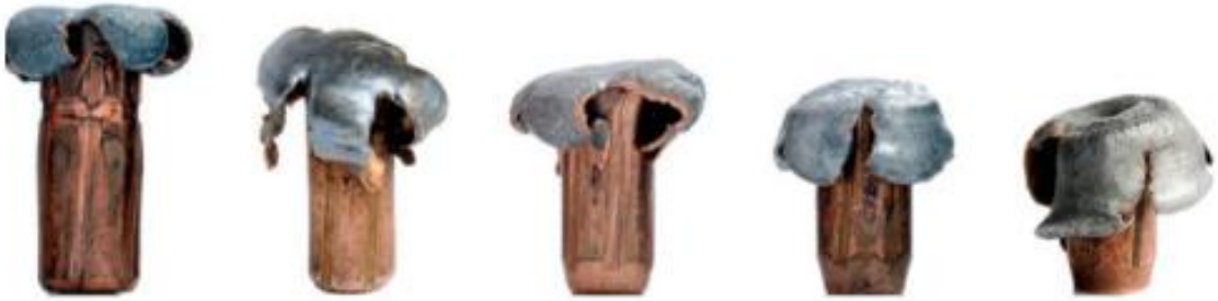
Slika 27. Ponašanje metka prilikom udarca u tijelo divljači
