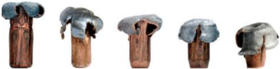
Slika 27. Ponašanje metka prilikom udarca u tijelo divljači
