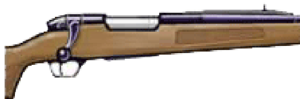
Slika 24. Cilindrični zatvarač sa korijenom ručice
