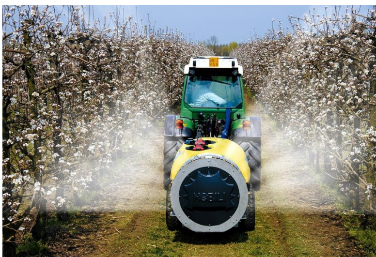
Slika 8. Pravilna aplikacija zaštitnog sredstva raspršivača. ( www.kokot-agro.hr )
