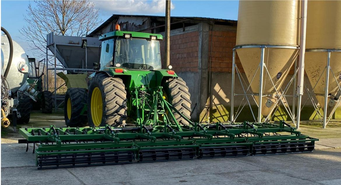
Slika 18. Sjetvospremač
