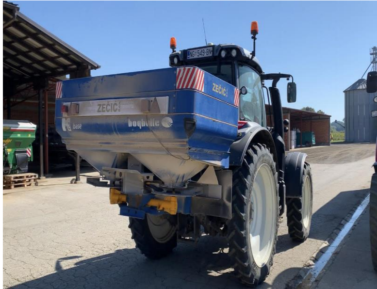
Slika 8. Rasipač (Izvor: Karlo Zečić)
