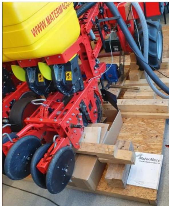
**Slika 5.** Sjetvene sekcije sijačice *MaterMacc Twin Row - 2*
