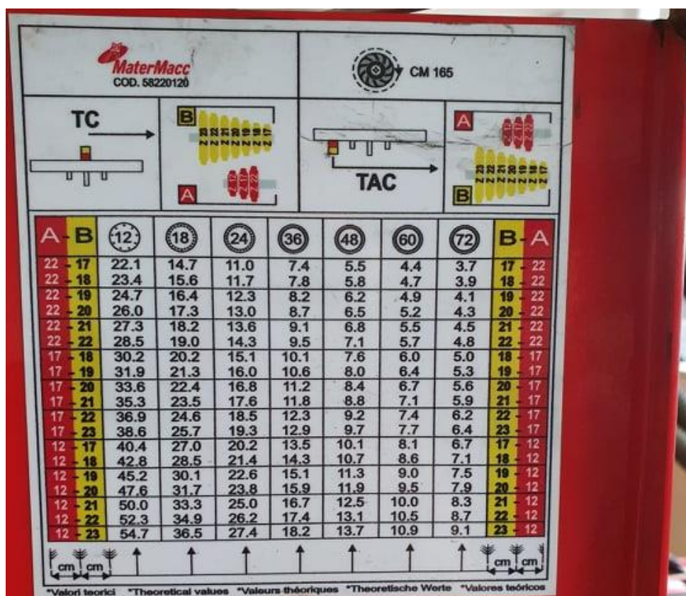
Slika 6. Sjetvena tablica izbor lančanog prijenosa kod sijačice MaterMacc Twin Row - 2
