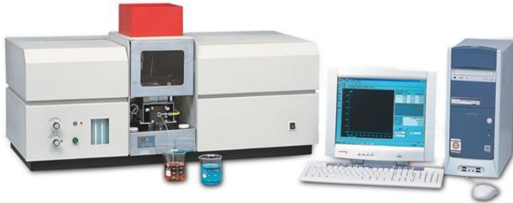
Slika 6.: Atomski apsorpcijski spektrofotometar Izvor: http://www.worldoftest.com/wfx-110a.htm
