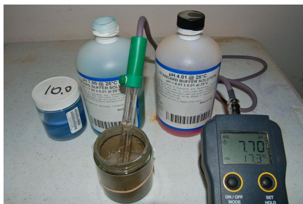
Slika 2.: Elektrometrijsko mjerenje pH metrom
