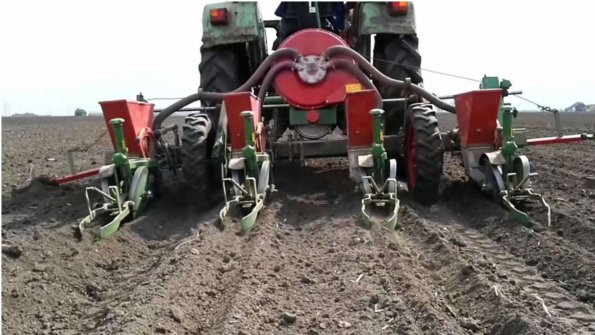
Slika 5. Pneumatska sijačica PSK4 (Izvor: A. Banaj)
