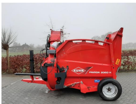
Slika 16. Distributer slame Kuhn Primor 2060 H (izvor: autor).
