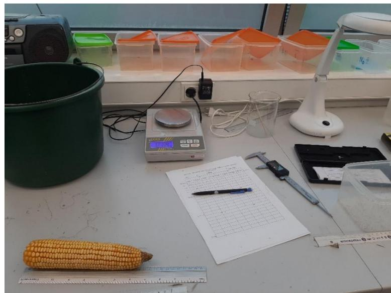
Slika 7. Mjerjenje dužine i težine klipa u laboratoriju (Izvor: Efinger, I.)
