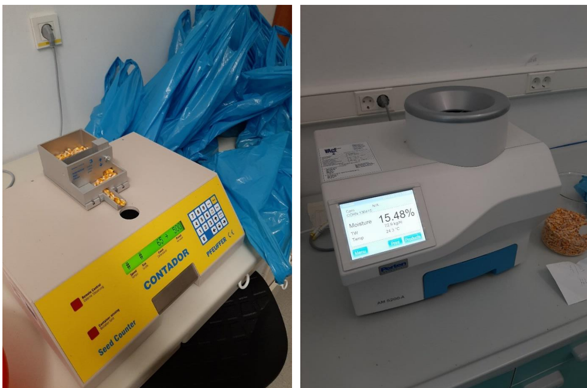
Slika 8. Uređaji za brojanje zrna i određivanje hektolitarske mase (Izvor: Efinger, I.)
