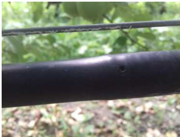
Slika 12. Predviđeni otvori (kapaljke) na plastičnim cijevima (Izvor: Vlastita fotografija)
