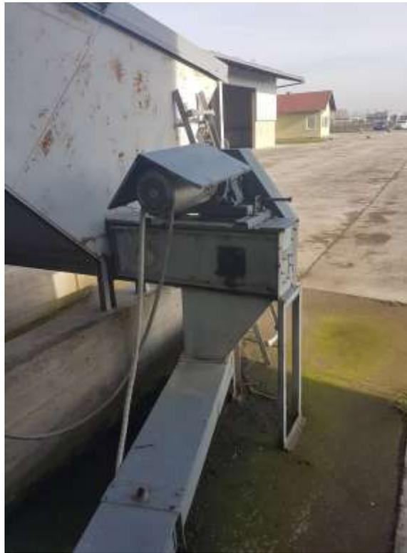
Slika 39. Pogonski mehanizam pužnog transportera
