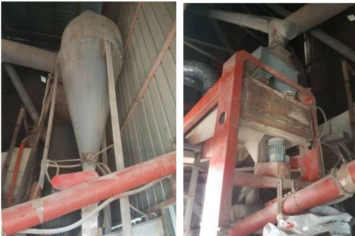
Slika 15. Ciklon (lijevo) i aspirator-selektor (desno)
