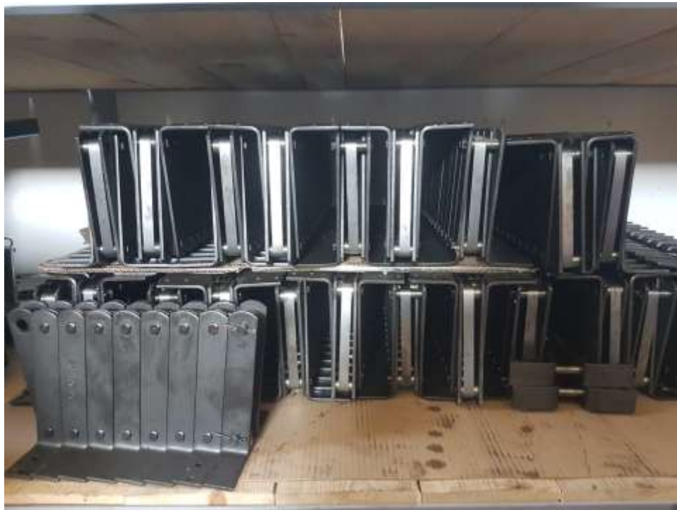
Slika 30. Ravni vučni lanac lančanog transportera u oklopu Redler (Izvor: Lukačević, M.)
