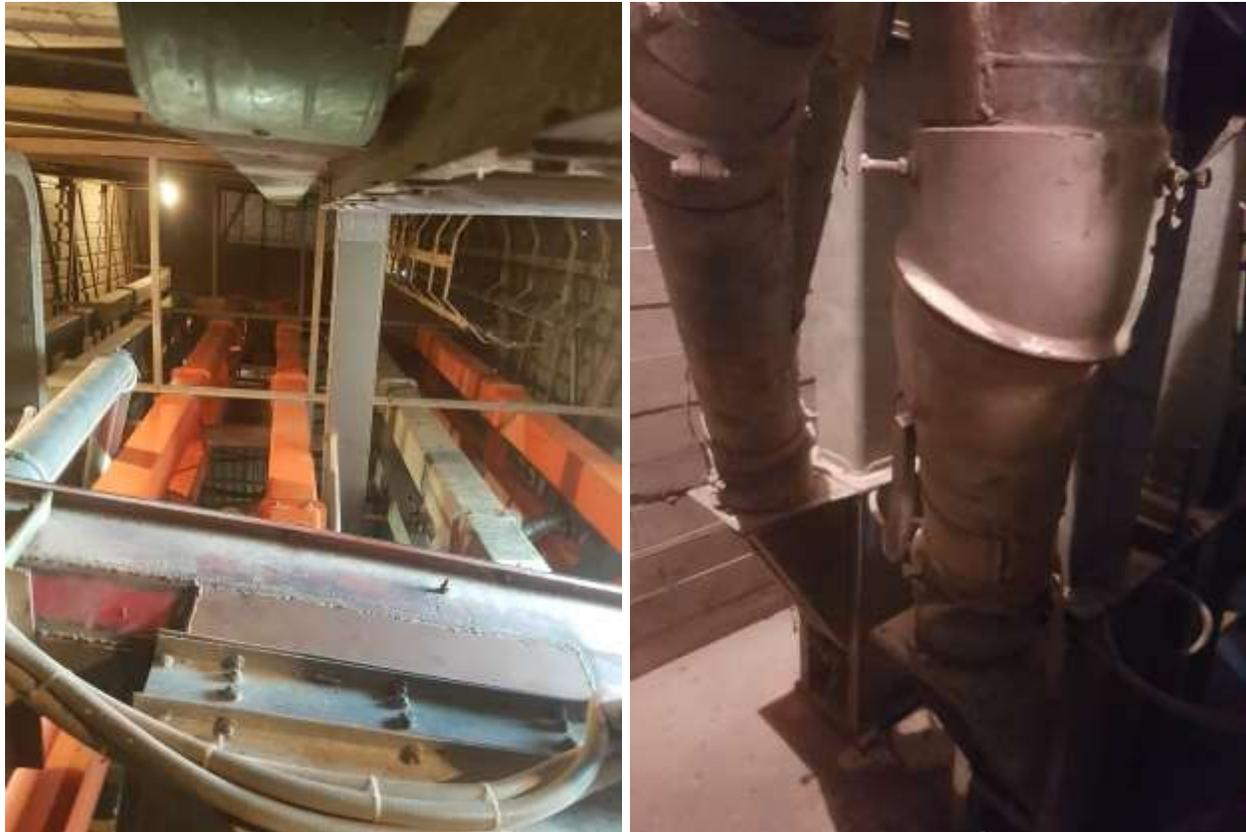
Slika 41. Elevatorske cijevi (lijevo) i stopalo (desno)
