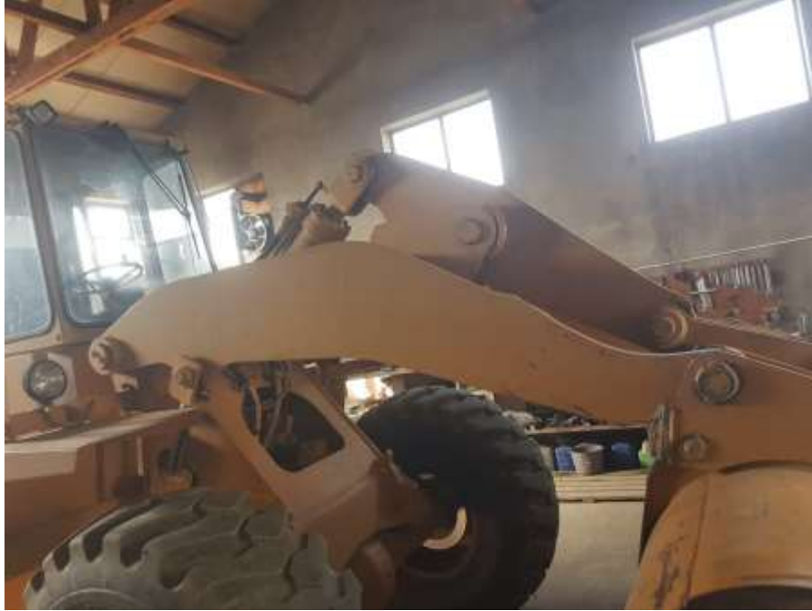
Slika 27. „Z“ mehanizam radnog organa
