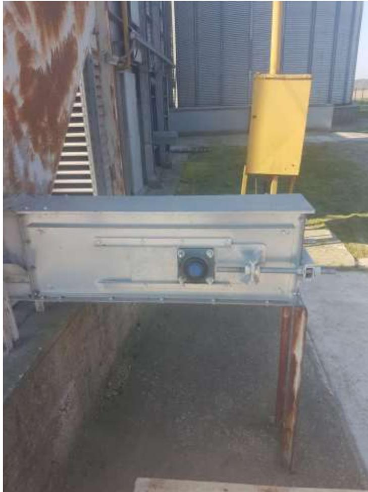
Slika 32. Zatezna glava lančanog transportera
