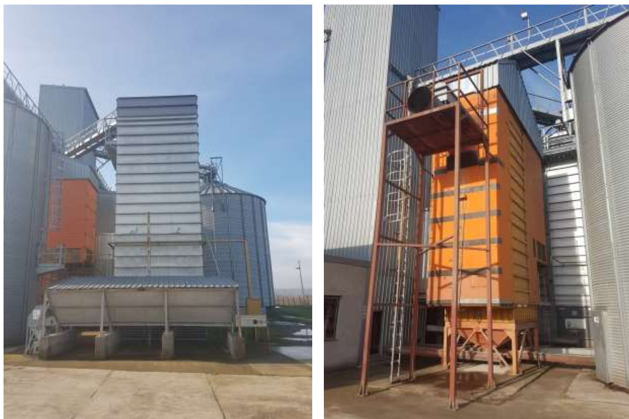
Slika 7. Strahl sušare s komorom za smještaj mase sjemena
