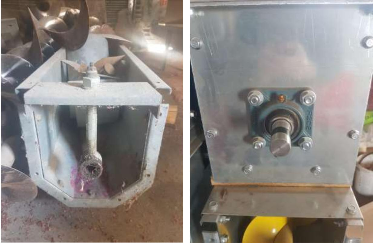
Slika 38. Unutarnji ležaj (lijevo) i čeoní ležaj (desno)
