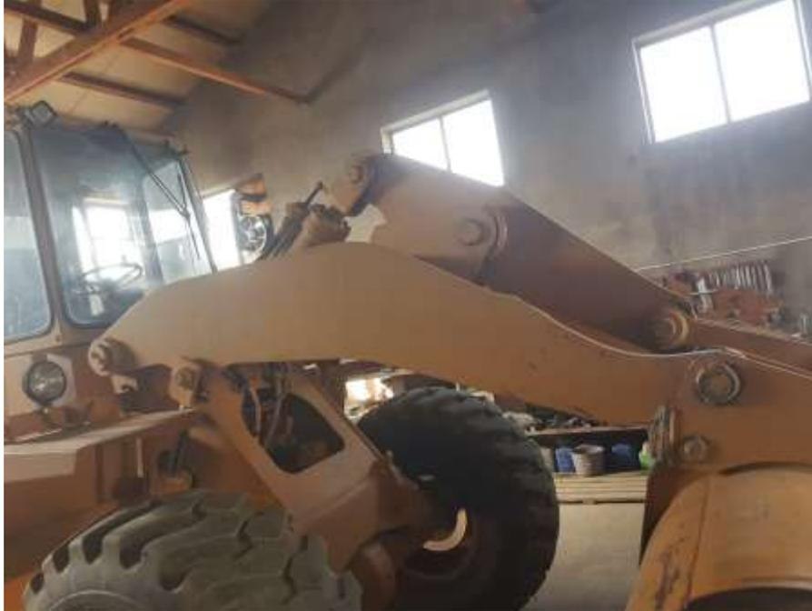
Slika 27. „Z“ mehanizam radnog organa
