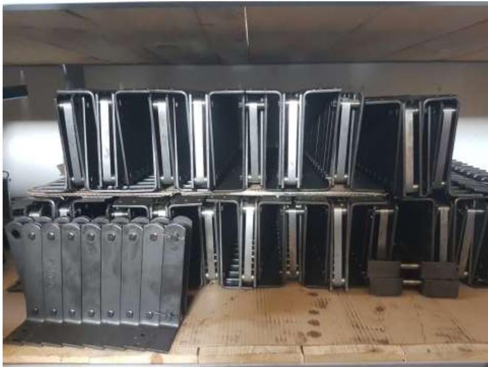
Slika 30. Ravni vučni lanac lančanog transportera u oklopu Redler
