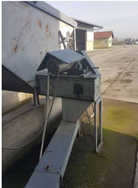
Slika 39. Pogonski mehanizam pužnog transportera (Izvor: Lukačević, M.)
