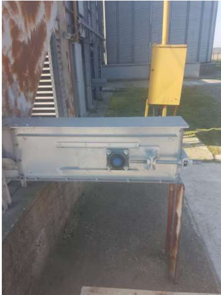
Slika 32. Zatezna glava lančanog transportera (Izvor: Lukačević, M.)
