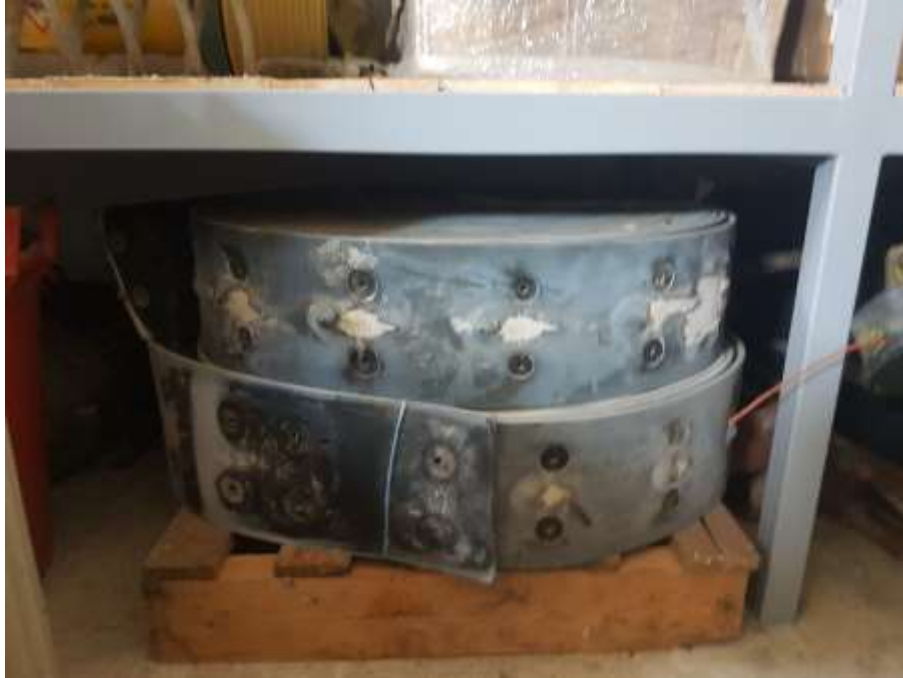
Slika 42. Traka elevatora vjedričara (Izvor: Lukačević, M.)
