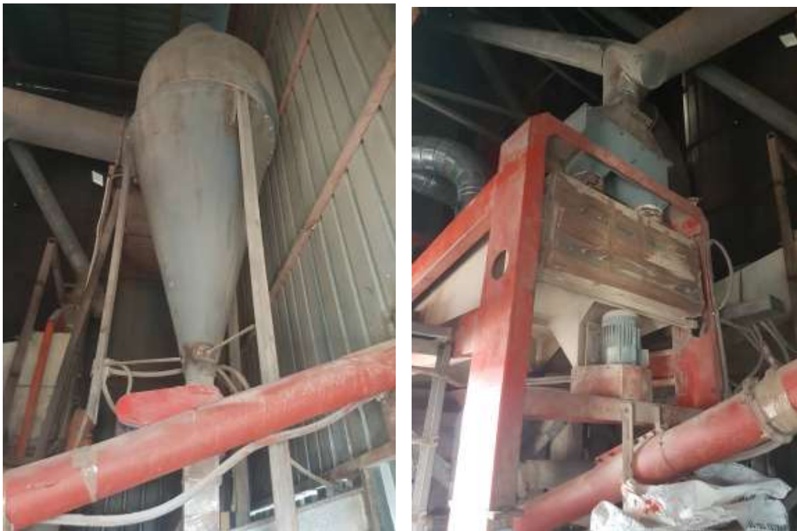
Slika 15. Ciklon (lijevo) i aspirator-selektor (desno)
