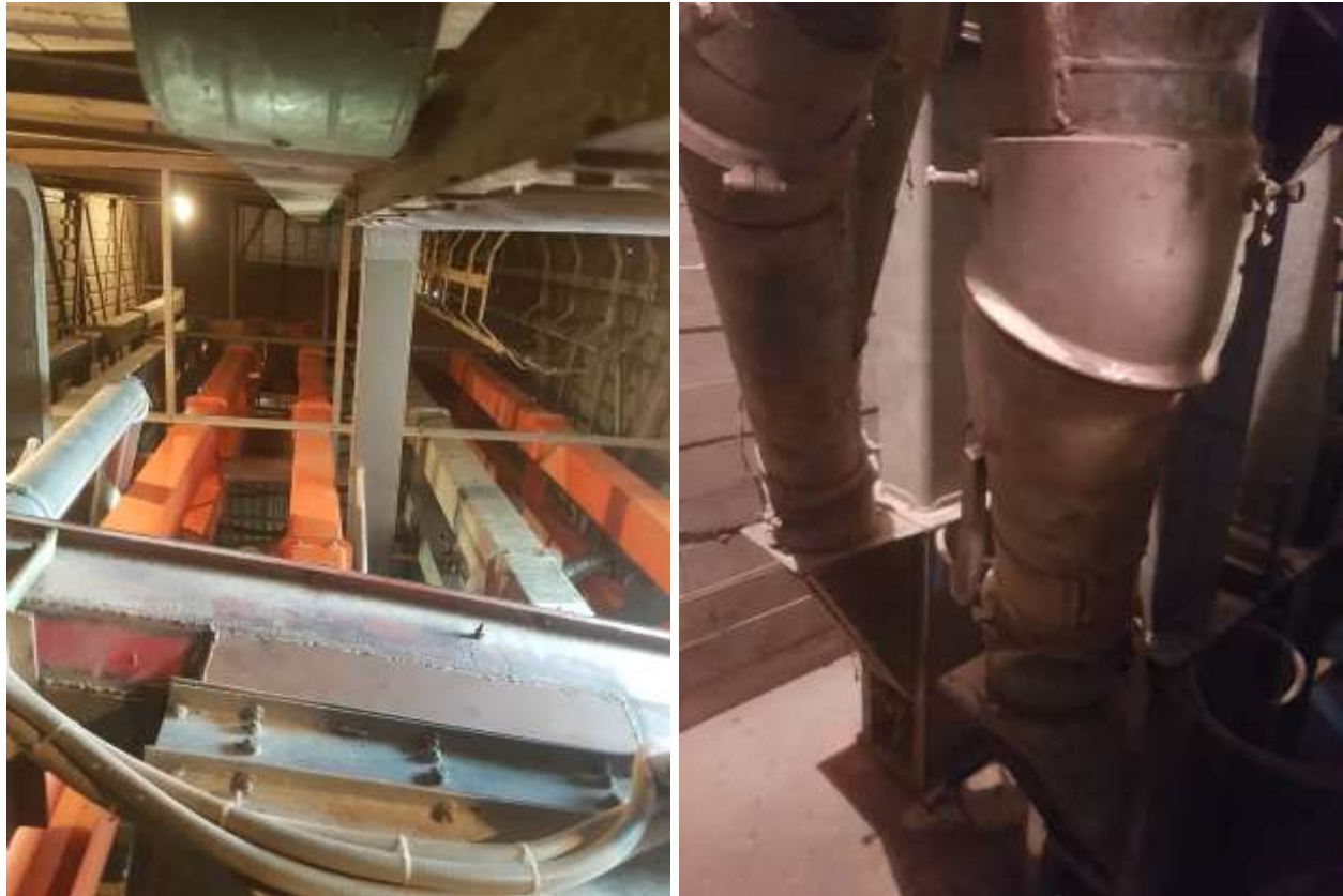
Slika 41. Elevatorske cijevi (lijevo) i stopalo (desno)
