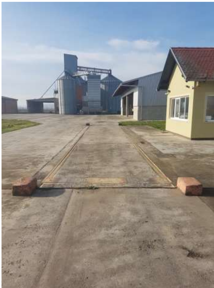
Slika 11. Prostor za analizu i vaganje uzoraka s kolnom vagom
