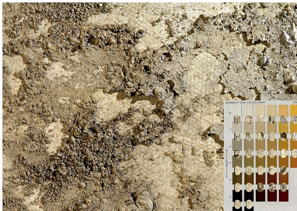
Slika 2. Određivanje boje tla na terenu pomoću Munsellovog atlasa
