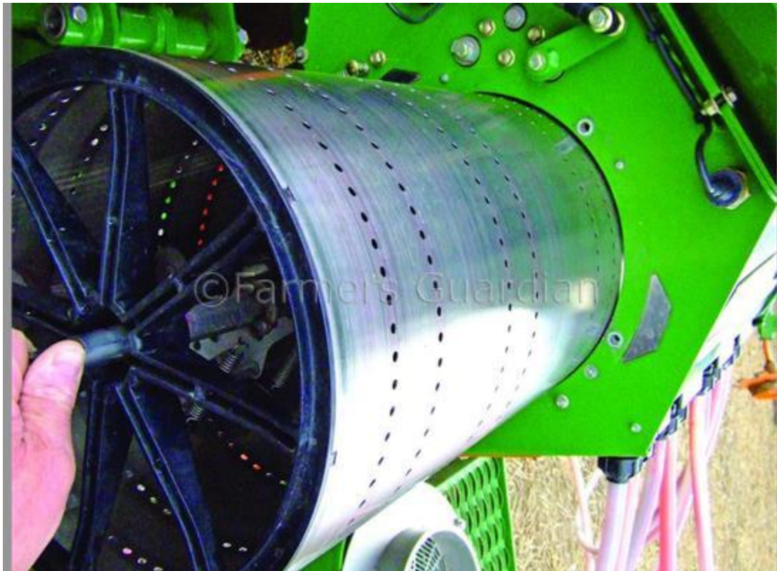
Slika 18. Bubanj Amazone EDX sjetvenog uređaja [18]
