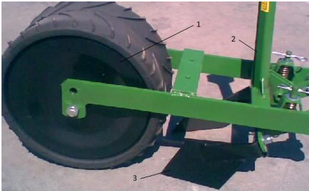
Slika 13. Zagrtači sjemena i nagazni kotač, 1. Nagazni kotač, 2. Nosač kotača, 3. Zagrtači sjemena [17]
