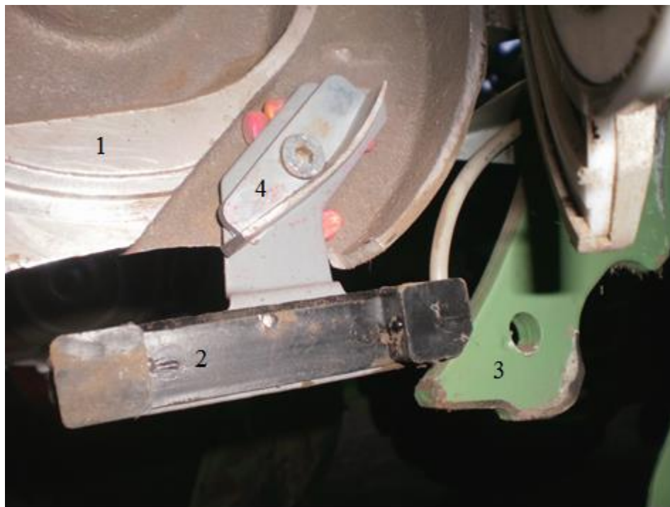
Slika 14. Senzor za kontrolu sjetve, 1. Kućište sjetvenog aparata, 2. Senzor za kontrolu sjetve, 3. Nosač sjetvenog uređaja, 4. Nosač senzora [17]
