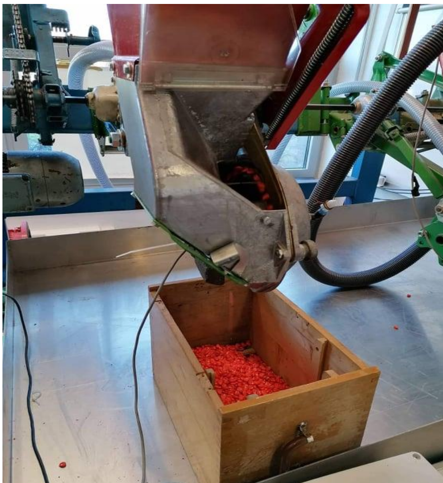
Slika 5. Sjetveni aparat PSK - OLT sijačice
