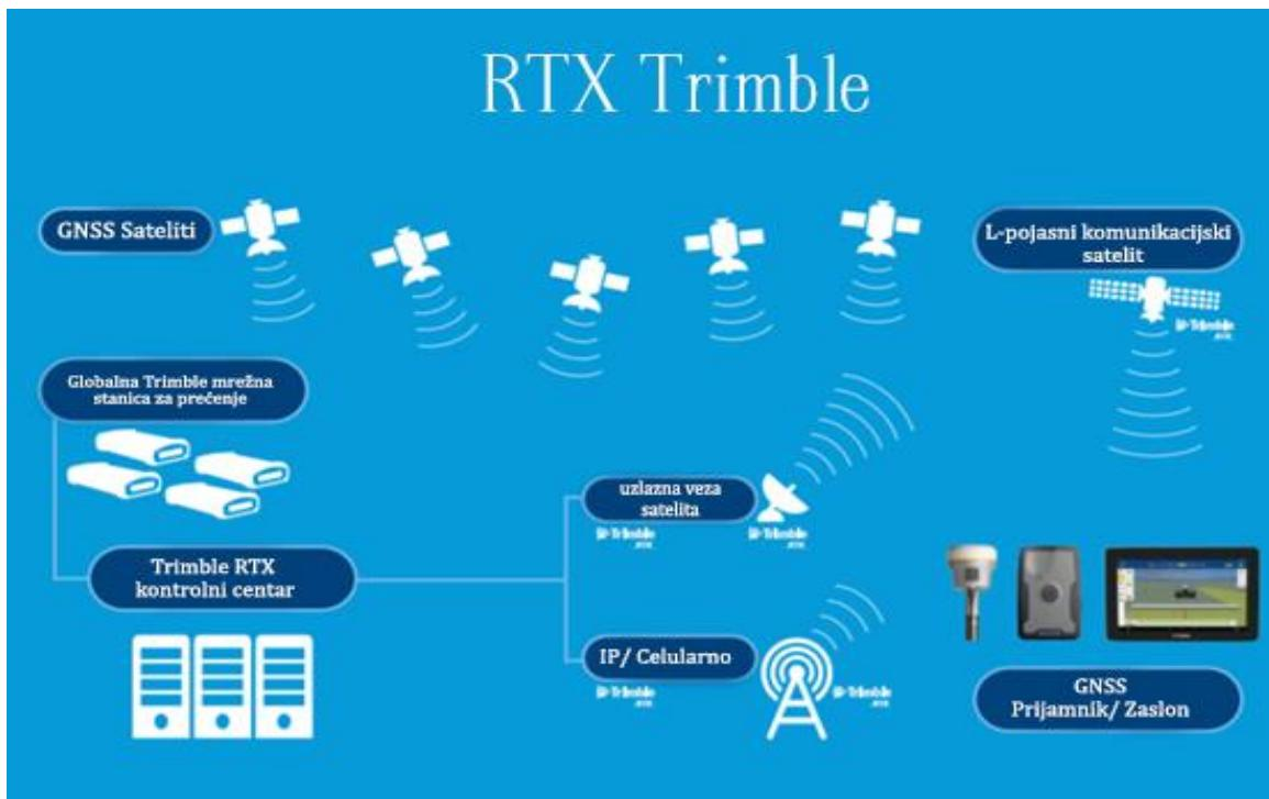
Slika 2. Način rada sustava Trimble RTX
