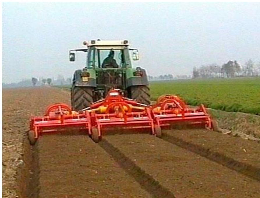
Slika 2. Primjer pripreme tla kombiniranim strojem (gredičar, rotofreza)
