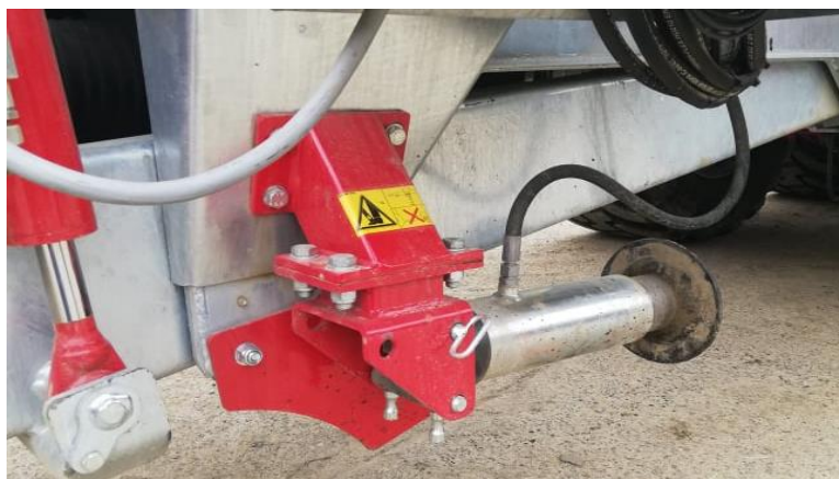
Slika 13. Potporni stup na cisterni Peecon Euroline (Izvor: Kolak, 2020.)
