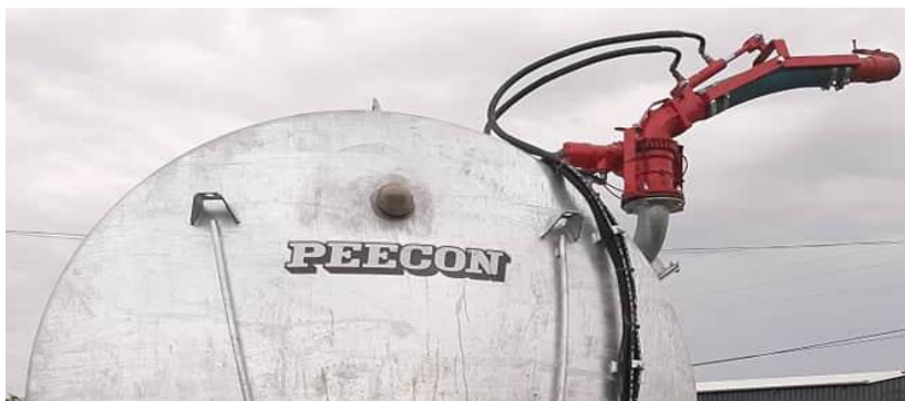
Slika 11. Top mlaznica u radnom položaju (Izvor: Kolak, 2020.)
