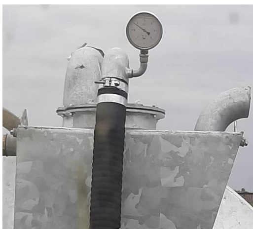
Slika 17. Tlakomjer u radu na cisterni Peecon Euroline (Izvor: Kolak, 2020.)
