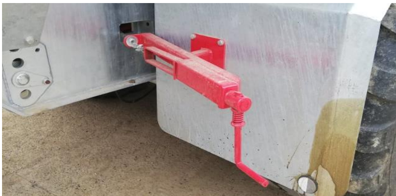
Slika 14. Ručna kočnica na cisterni Peecon Euroline (Izvor: Kolak, 2020.)
