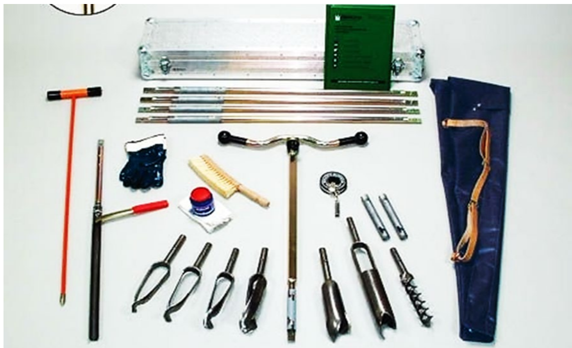
Slika 11. Set sondi i svrdla za uzorkovanje tla
