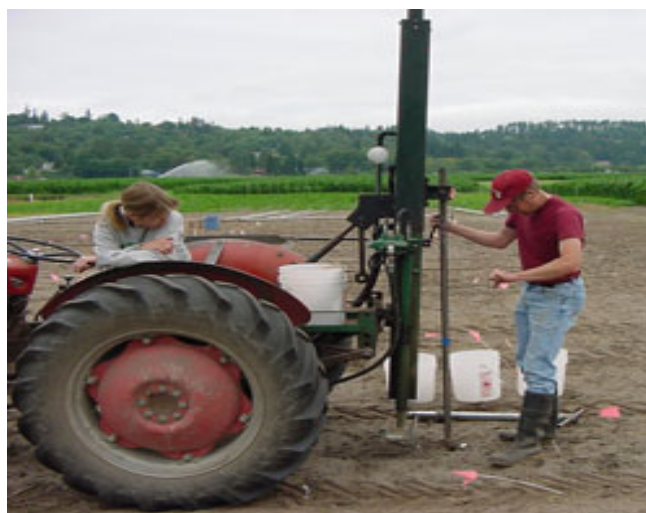
Slika 2. Priključna hidraulička sonda
