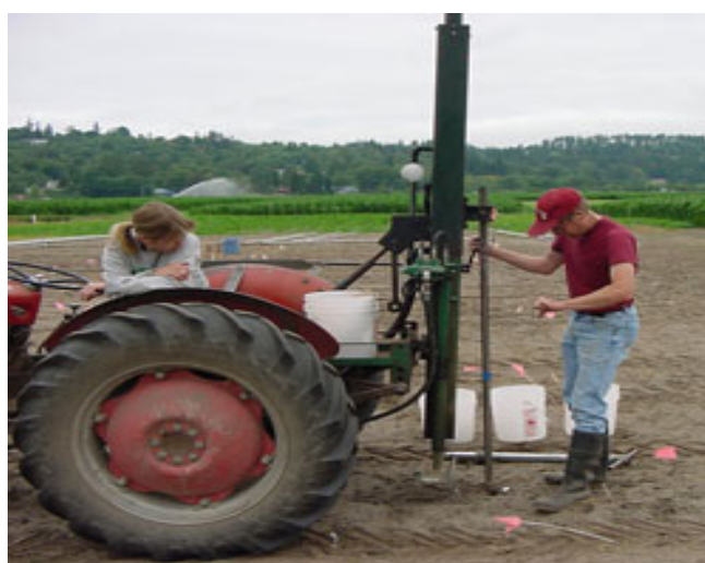
Slika 2. Priključna hidraulička sonda
