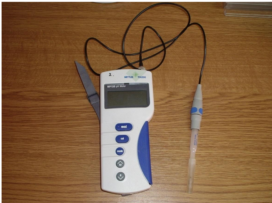
Slika 8. Digitalni pH-metar Mettler MP 120-B (foto: Z. Kralik, 2013.)
