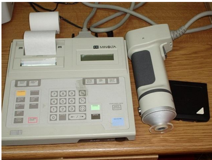
Slika 5. Minolta CR-300 kolorimetra (Minolta Camera Co. Ltd., Osaka Japan)
