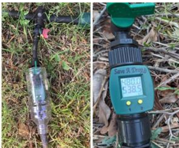
Slika 10. Prikaz mjerača protoka vode korištenog u istraživanju (Izvor: Zorica M., 2019.)
