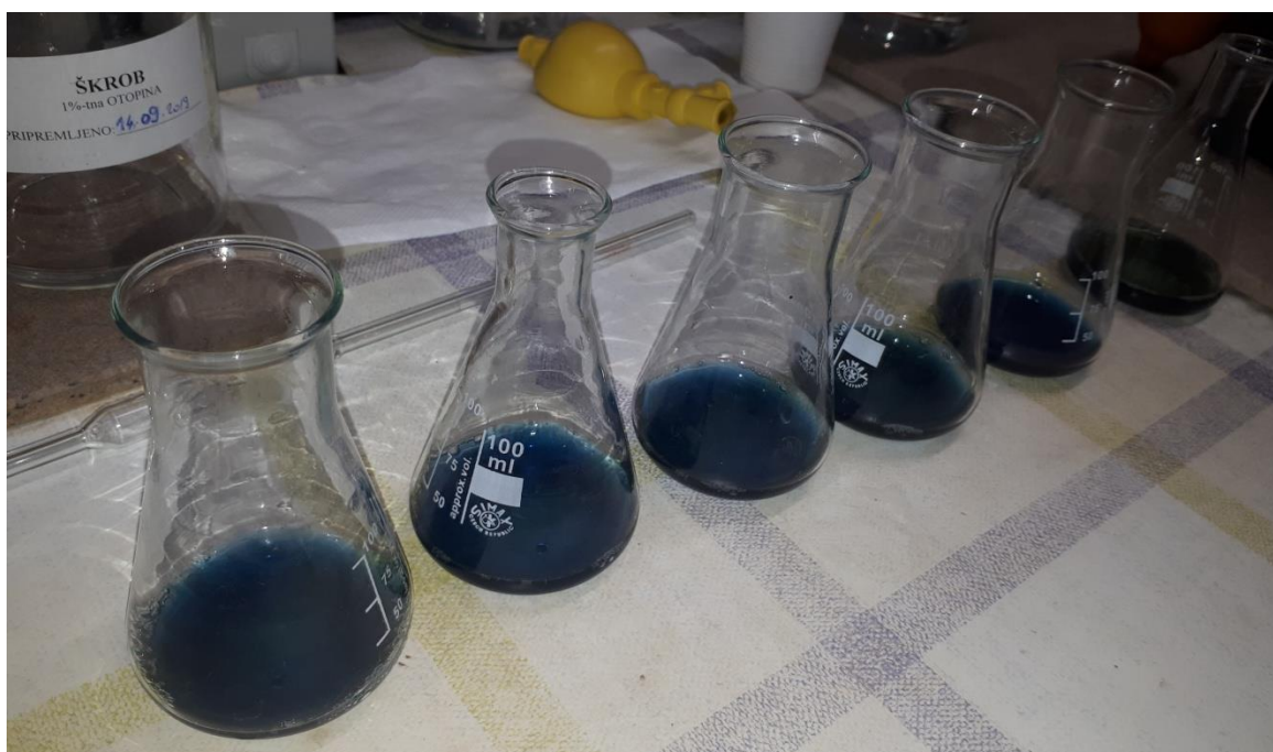
Slika 11. Uzorci mošta nakon titracije
