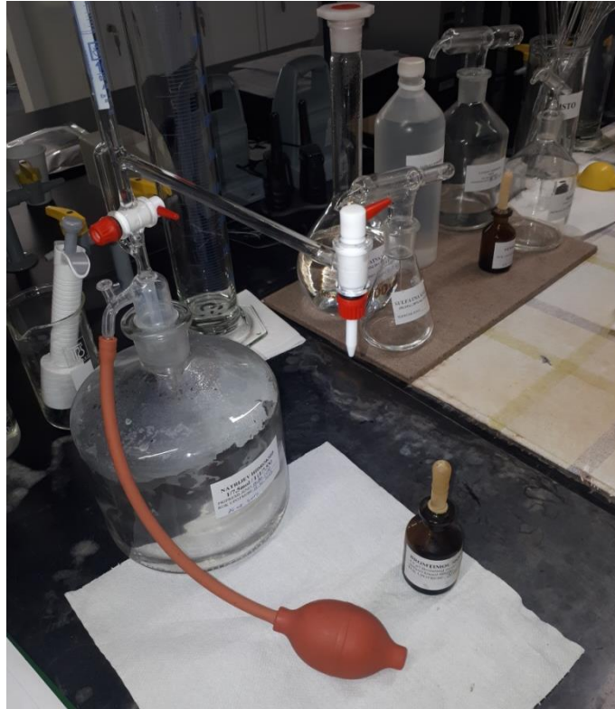
Slika 10. Određivanje ukupnih kiselina u moštu titracijom
