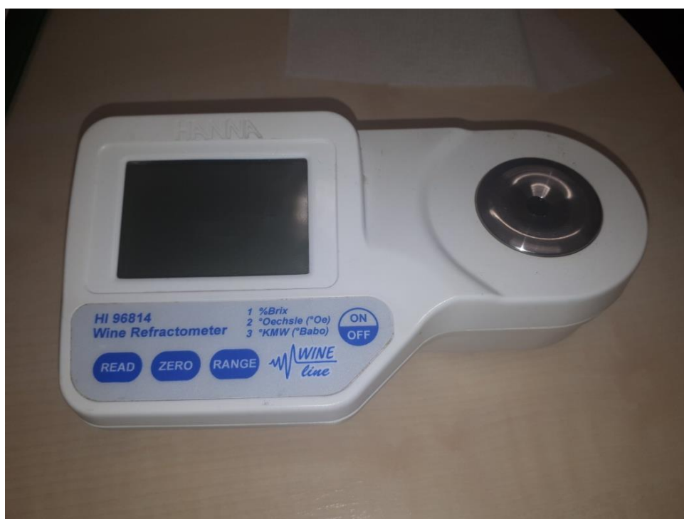
Slika 8. Refraktometar- uređaj za mjerenje šećera
