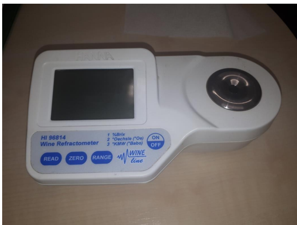
Slika 8. Refraktometar- uređaj za mjerenje šećera
